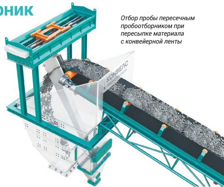
Отбор пробы пересечным пробоотборником при пересыпке материала с конвейерной ленты
